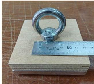
圖4 載重板鐵環尺寸示意圖
