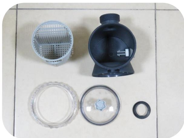
圖 10 除毛器零件
