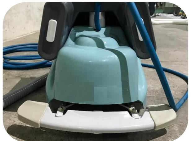
圖 21 水底吸塵器
